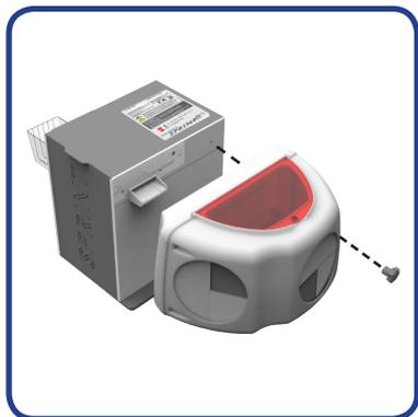
**3.** Аккуратно продвиньте загрузчик дневного света к корпусу машины через направляющую для ввода пленки. Плотнo прижмите загрузчик к корпусу проявочной машины.
