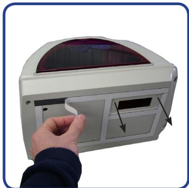
**1.** Открутите два фиксирующих винта. Сохраните их. Снимите белую защитную ленту с уплотнителя с обратной стороны загрузчика дневного света.
