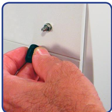
**2.** Снимите черные колпачки со шпилек на передней панели.
