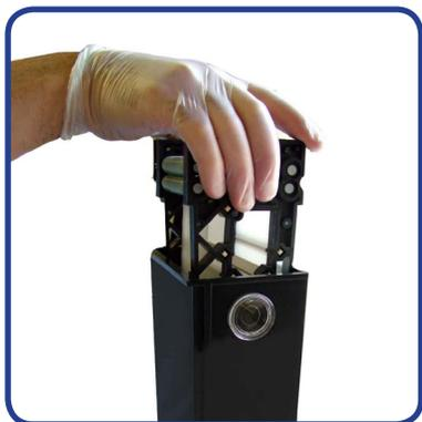
3. Достаньте транспортировочные модули и поместите их в мойку с краном и сливным отверстием. Промойте модули под проточной водой. Важно не допускать высыхания химреактивов на лентах.
